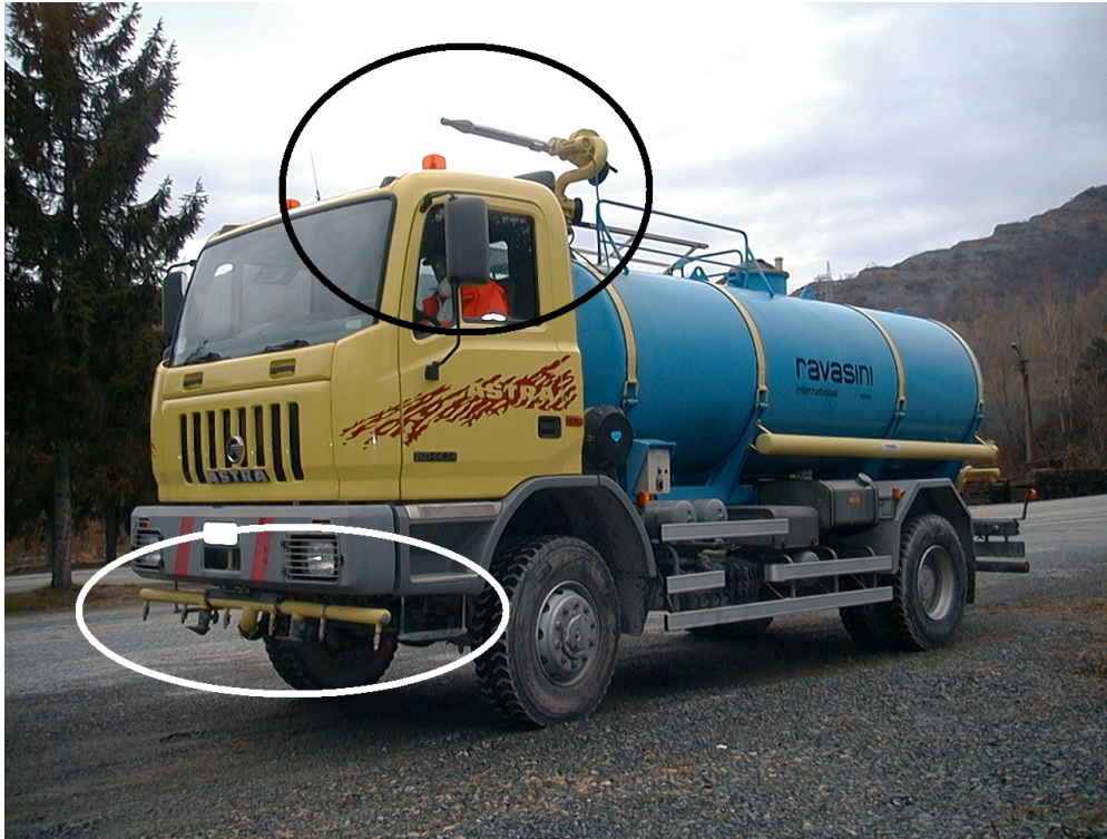
fig. 3 - autobotte con sistema di bagnatura a distanza
