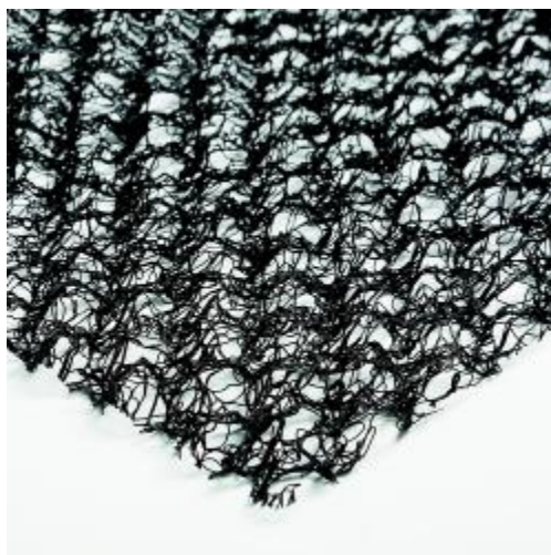
fig. 11 - Geostuoia grimpante in filamenti di polipropilene idonea all'intasamento con materiale terroso, rivegetabile con idrosemine a mulch e utilizzata per la sistemazione delle sponde delle canalette
