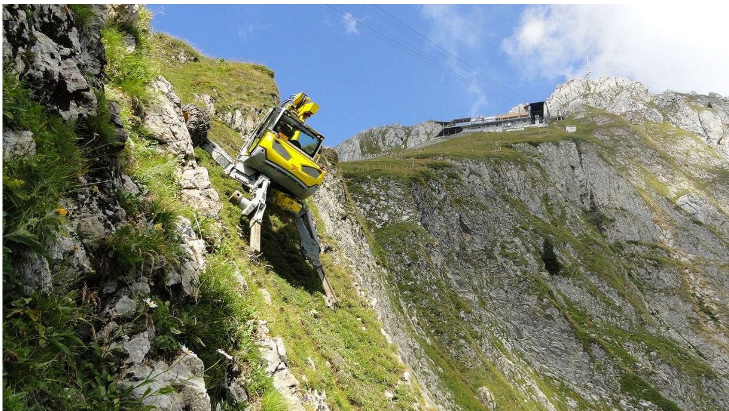
fig. 5 - Utilizzo di ragno meccanico vincolato con fune in condizioni di elevata acclività
